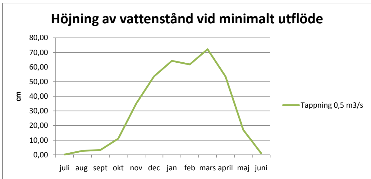
Figur 2 Höjning av vattenståndet vid utflödet Q_{ut}=0,5 \text{ m}^3/\text{s}
