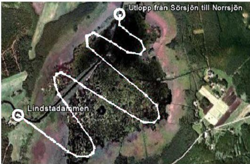
Figur 24: Figuren visar den planerade rännans utformning i Sörsjön (Karta: www.google.se ).
